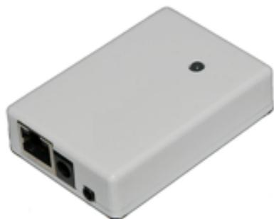
Pour contrôler les équipements infra-rouges, Soline utilise une télécommande universelle pilotable par le réseau informatique. Une telle télécommande peut commander tous les équipements qui sont dans son champ de vision ou jusqu'à six équipements différents si le module est «caché» dans une armoire. L'utilisateur peut ainsi la commander avec des ordres aussi simples que «Soline, je veux regarder TF1» ou «Soline, chaîne suivante».
